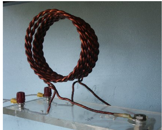
Bild 2.1: Luft-PUT bei DJ9LI, Rudolf Wattenscheid hinter einem unsymmetrischen, kommerziellen Antennenkoppler, am Fußpunkt der Hühnerleiter, geschaltet
