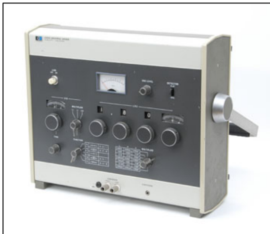
Bild 3: HP 4265 A Universal Messbrücke aus dem Jahre 1973 für R, L, C, D und Q
