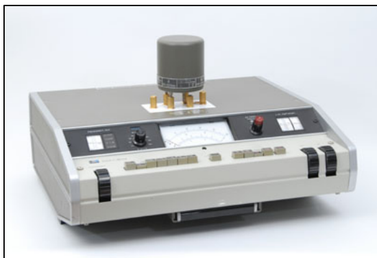
Bild 4: HP 4342, Q-Meter aus dem Jahre 1970
