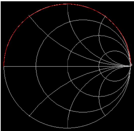
**Bild 2:** Ideale Induktivität
