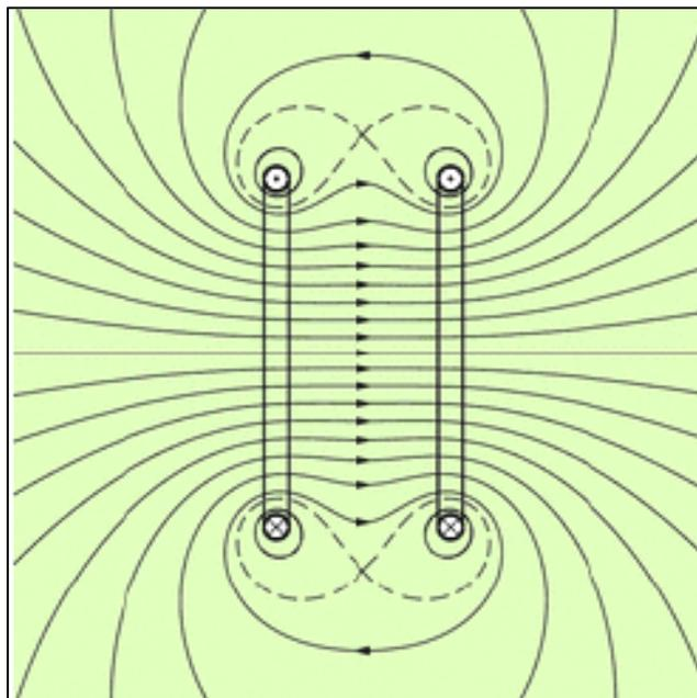
**Bild 4.** Das magnetische Feld innerhalb einer Helmholtz-Spule
