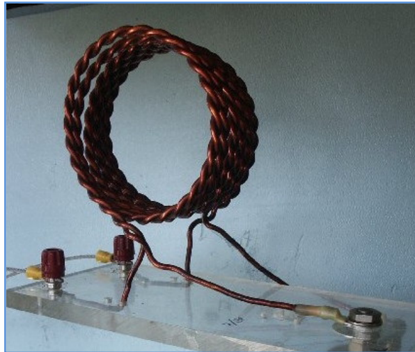
Bild 3.1: Ein 1:1 HF-Luft-Übertrager bei DJ9LI †, Rudolf in Bochum, geschaltet hinter seinem kommerziellen Anpassgerät KTA mit dem Sender KSG 1300.
