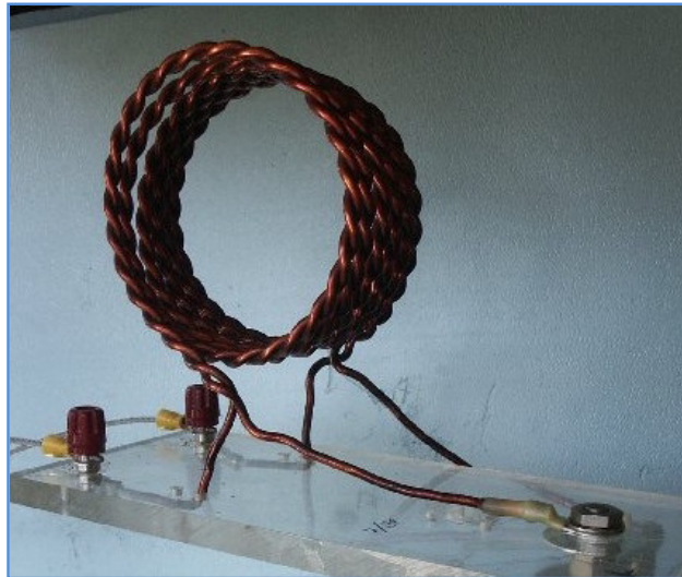
Bild 3.1: Der 1:1 HF-Luft-Übertrager bei DJ9LI †, Rudolf in Bochum, geschaltet hinter seinem kommerziellen Anpassgerät KTA mit dem Sender KSG 1300.
